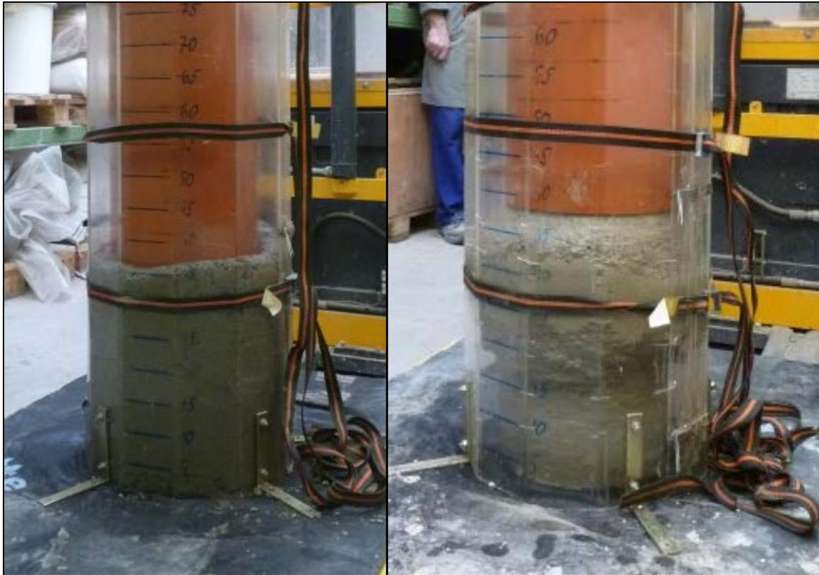
Abbildung 1: Darstellung des Nachfließverhaltens im Labormaßstab mittels Bohrpfahlsimulationsgerät
