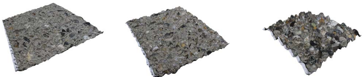
Abbildung 1: Oberflächenmodell der glatten (links), rauen (Mitte) und verzahnten (rechts) Oberfläche
