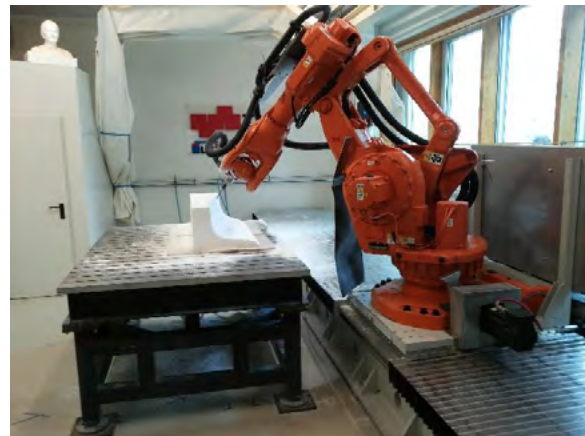
Abbildung 3: Herstellung der Außenschalung für das Kanu mittel Fräsroboter (c) Betonkanu TU Graz
