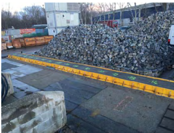
Abbildung 2: Herstellung der Probeplatten für die Ermüdungsprüfung
