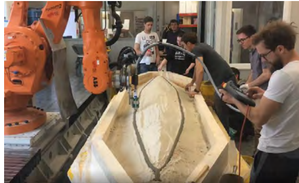
Abbildung 5: Herstellung des 3D gedruckten Betonkanus Printess Layer (c) Betonkanu TU Graz
